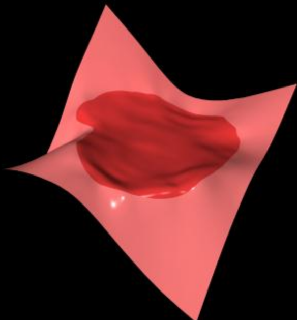
Costruzione superficie NURBS dalle sezioni estratte dalla superficie Mesh. E' stato utilizzato il software di modellazione Rhinoceros.
